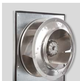
Centrifugaal waaier met achterovergebogen schoepen Ter voorkoming van vuilophoping. Dynamisch gebalanceerd.
